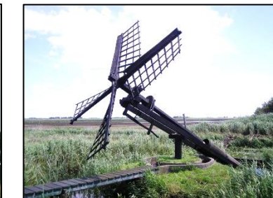
Eenvoudige windbemaling met scheprad of vijzel
